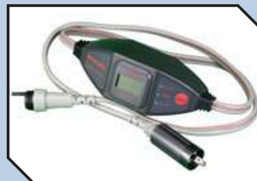
Artikelnummer: ENGBMIL Bezeichnung: ENGEL Batteriemonitor mit Originalstecker für ENGEL InLine Beschreibung: Mit dem Original ENGEL Batteriemonitor sind Sie auf der sicheren Seite. Dieser schaltet beim Erreichen der eingestellten Batteriespannung automatisch ab. Sie können die Ausschaltspannung bequem zwischen 10,5V und 11,5V auswählen. Wird ganz einfach mit dem 12V Originalkabel verschraubt.
