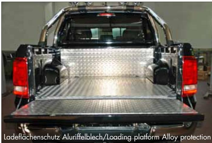
Ladeflächenschutz Aluriffelblech/Loading platform Alloy protection
