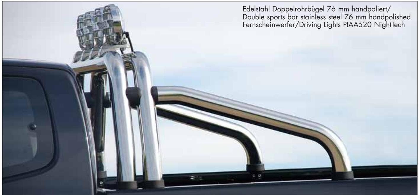
Edelstahl Doppelrohrbügel 76 mm handpoliert/
