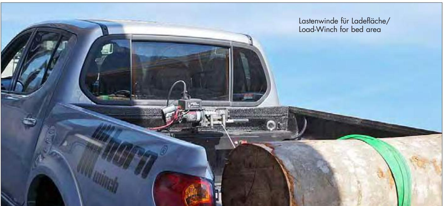
Lastenwinde für Ladefläche/
