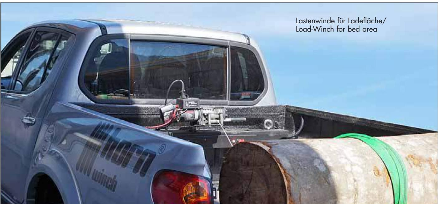
Lastenwinde für Ladefläche/
