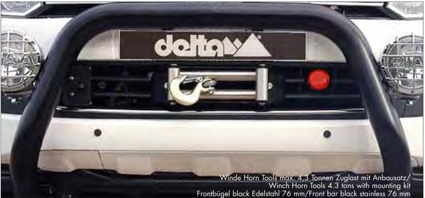
Winde Horn Tools max. 4,3 Tonnen Zuglast mit Anbausatz/
