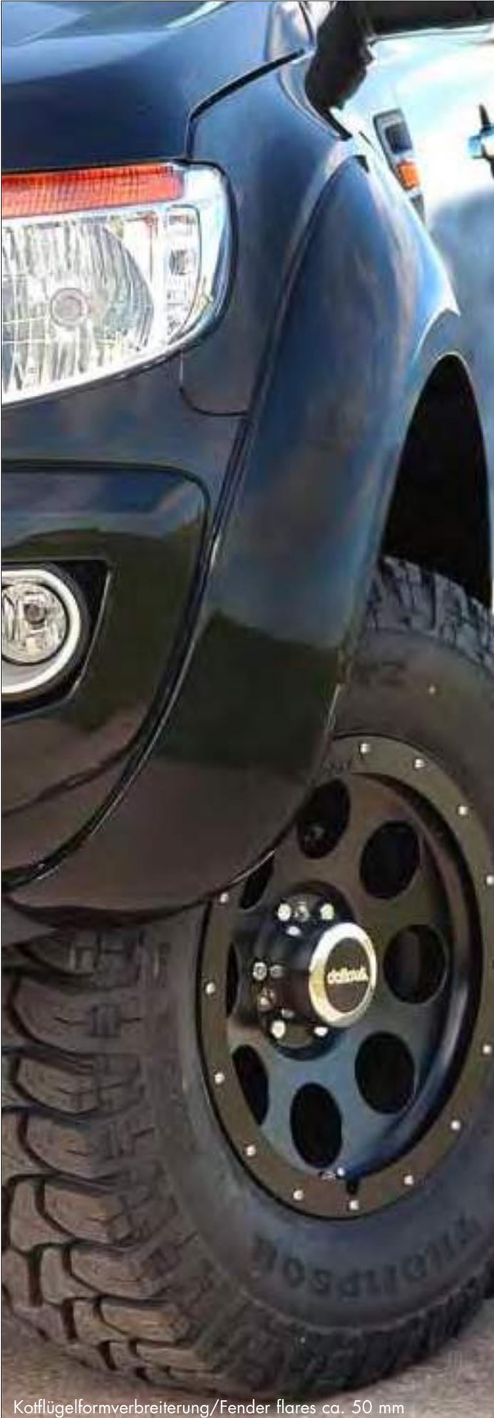
Kotflügelverbreiterung/Fender flares ca. 50 mm
